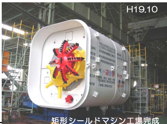
写真 - 2 出入口連絡通路工（矩形シールド） 5
