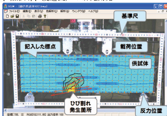
図-1 実験中のひずみ分布(供試体の载荷実験)
