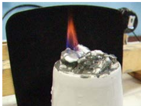
写真1 メタンハイドレート燃焼の様子 (写真中、白い部分がメタンハイドレート)
