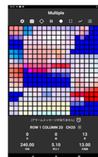
画像処理アプリで仮に 400 本の POF センサーを同時にモニタリングした場合のディスプレイの表示例。現在の状態で、このアプリでは 900 本の POF センサーを同時処理できる仕組みとなっている。
