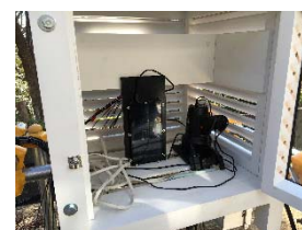
アンドロイド OS のタブレット内蔵カメラで POF センサーのボードに集約された光データを記録している様子。
