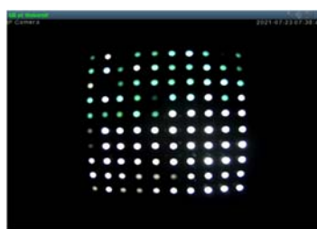
100 個の POF センサーを収めるためのボックスをカメラで確認している様子。写真が撮られた時点では、45 個の POF センサーが光情報を捉えている状態。
