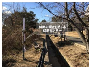
太陽光を利用して作動する傾斜センサー
