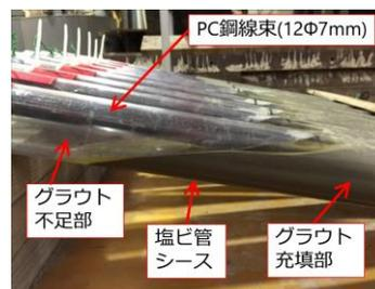
図-1 PC鋼線束の促進腐食試験体（塩ビ管シース）
