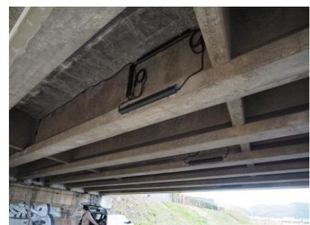
図-7 FBG 光センサーの設置状況
