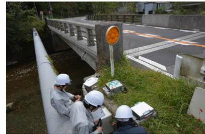
図-4 PC 鋼材の補修後モニタリング状況
