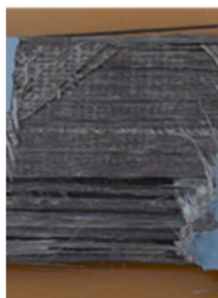
図-2 実験で使用した GFRP 材料と部材（試験後） 1)
