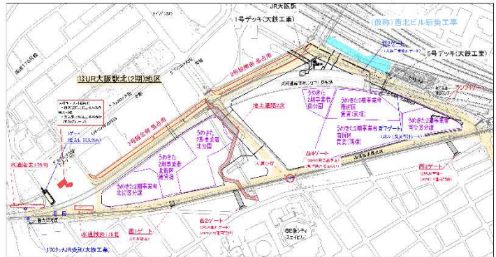
うめきた 2 期地区の平面図および工事輻輳状況
